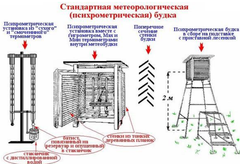
Рис. 3. Психрометрическая будка (общий вид)
